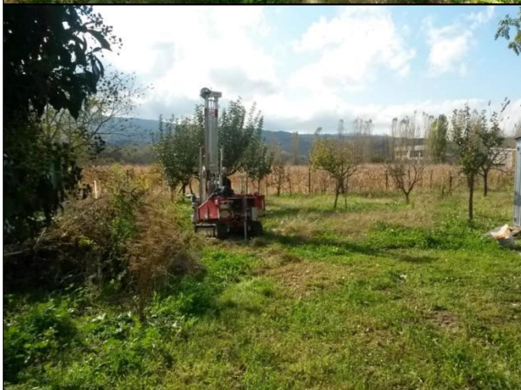
**- Esecuzione prova penetrometrica CPT6 – CPT613**
