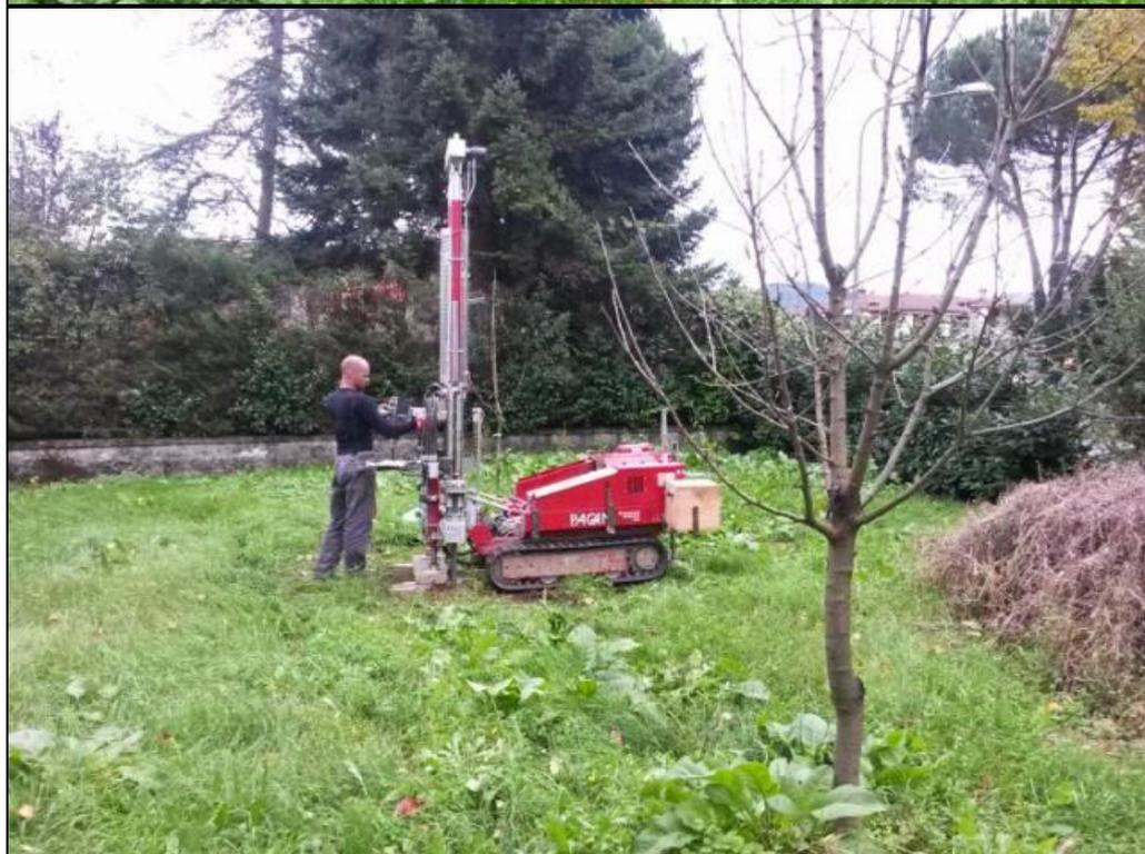
**- Esecuzione prova penetrometrica CPT7**
