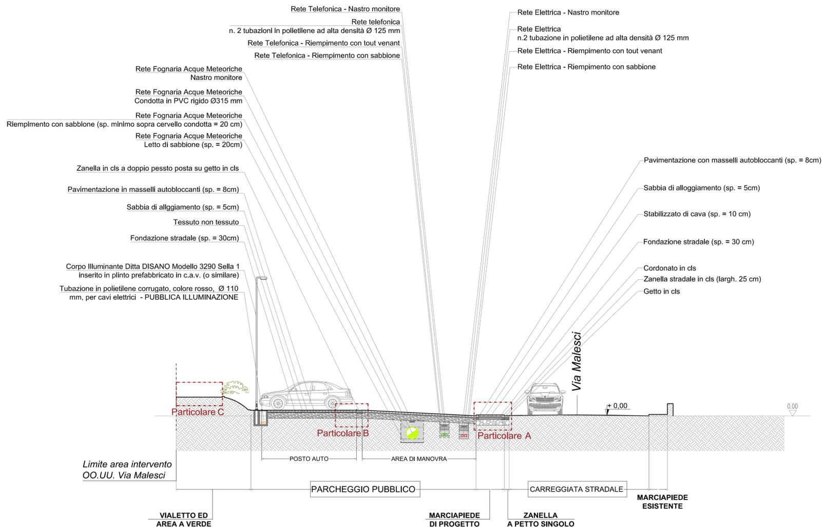
Nota: Il posizionamento delle infrastrutture delle Reti Tecnologiche sono riportate nelle tavole della Sezione "RETI TECNOLOGICHE".
