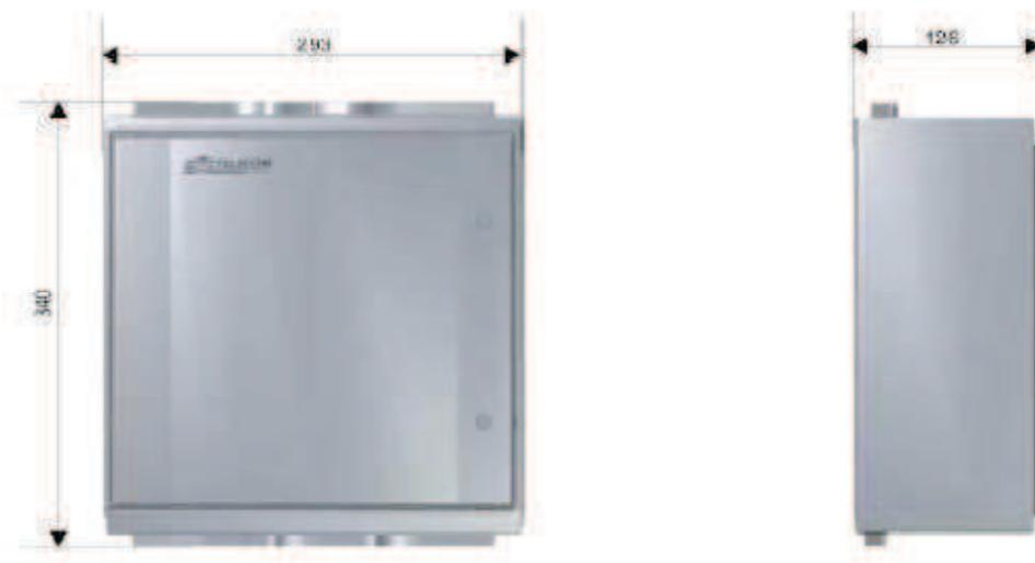
L'armadietto modulare può essere installato ad incasso nei muri o posato a sbalzo. Quando il muro non è di spessore adeguato, l'armadietto può essere incassato parzialmente. In quest'ultimo caso il fissaggio si realizza mediante viti e tasselli ad espansione.
